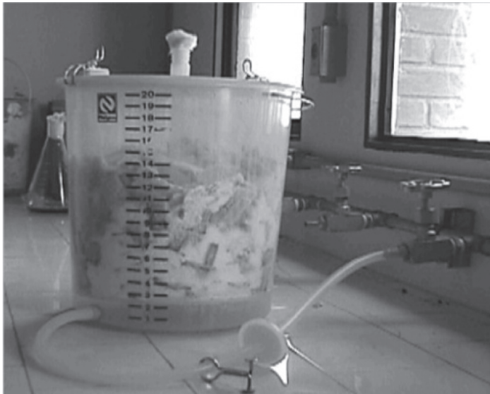
Figura 16.4 Biorreator aerado com ar umidificado com cavacos de madeira, inoculado com Ceriporiopsis subvermispora .
