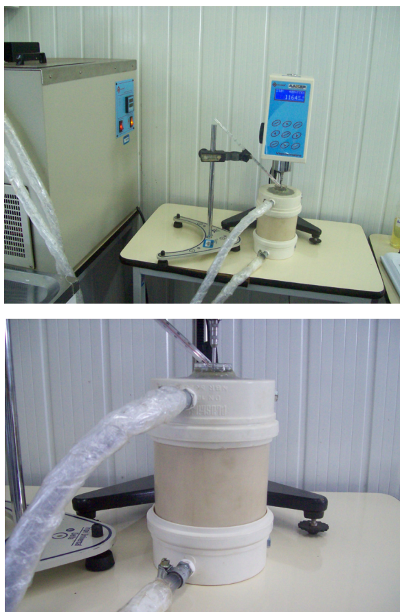
Figura 4.5 Fotografia do viscosímetro da marca Quimis com porta amostra acoplado ao banho termostático, desenvolvido pelo Grupo de Pesquisa de Fluidos Complexos da UTFPR
