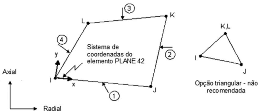
**Figura 4.5** Elemento estrutural PLANE 42 (Manual do ANSYS® 6.0).
