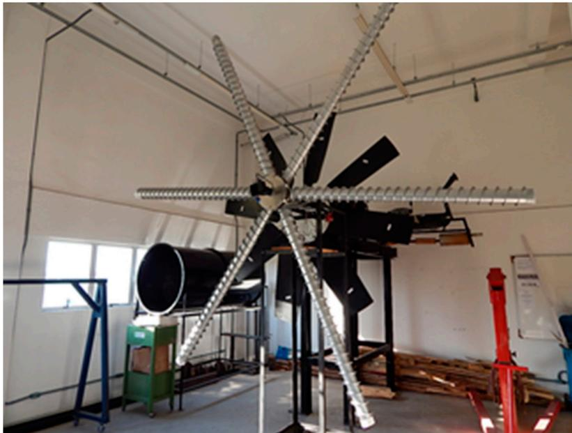
**Figura 6** Turbina eólica de efeito Magnus de 3 m de diâmetro.
