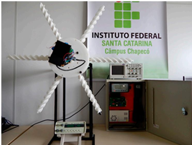
**Figura 1** Protótipo de turbina eólica Magnus de 1 m de diâmetro.
