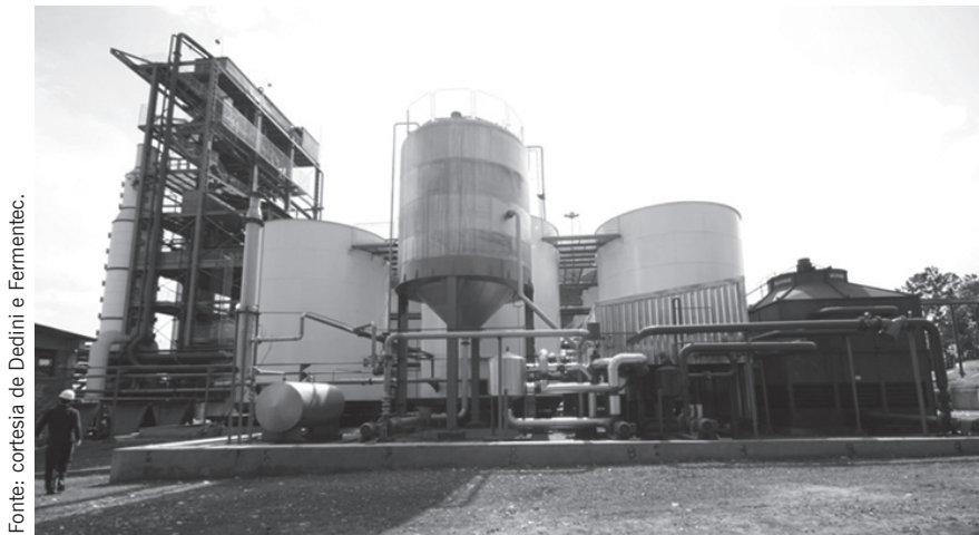
Figura 67: Visão geral da planta Ecoferm, com fermentação de alto teor alcoólico utilizando resfriamento com água gelada.
