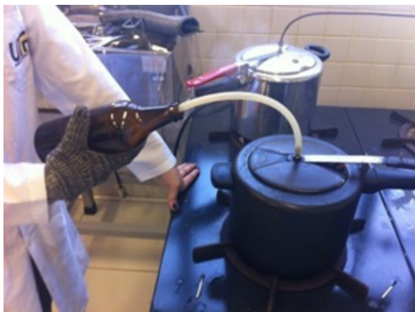
Figura 1.6 Fotografia do procedimento de esterilização das garrafas por injeção de vapor
