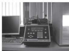
Figura 13.9 Equipamento para medição do ponto de fluidez.
