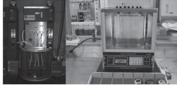
Figura 13.8 Equipamentos para medição da viscosidade cinemática.
