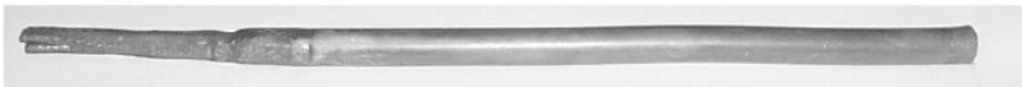
Figura 6.2 – Tubo de cobre comercial com a mistura de pós de Ni e Ti pré-compactado em seu interior.
