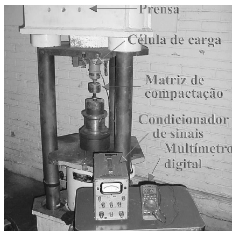
Figura 3.7 – Equipamento existente no LdTM/UFRGS utilizado para as compactações dos billets de Nitinol.
