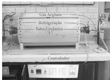
Figura 3.8 – Forno de sinterização fabricado no LdTM/UFRGS.
