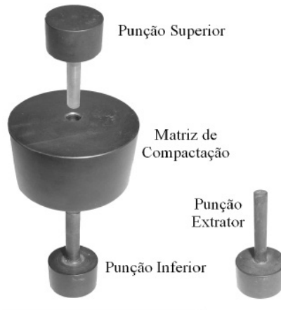
Figura 3.6 – Matriz de compactação e punções fabricados no LdTM/UFRGS para obtenção dos billets de 8,3mm de diâmetro e 12,45mm de altura.
