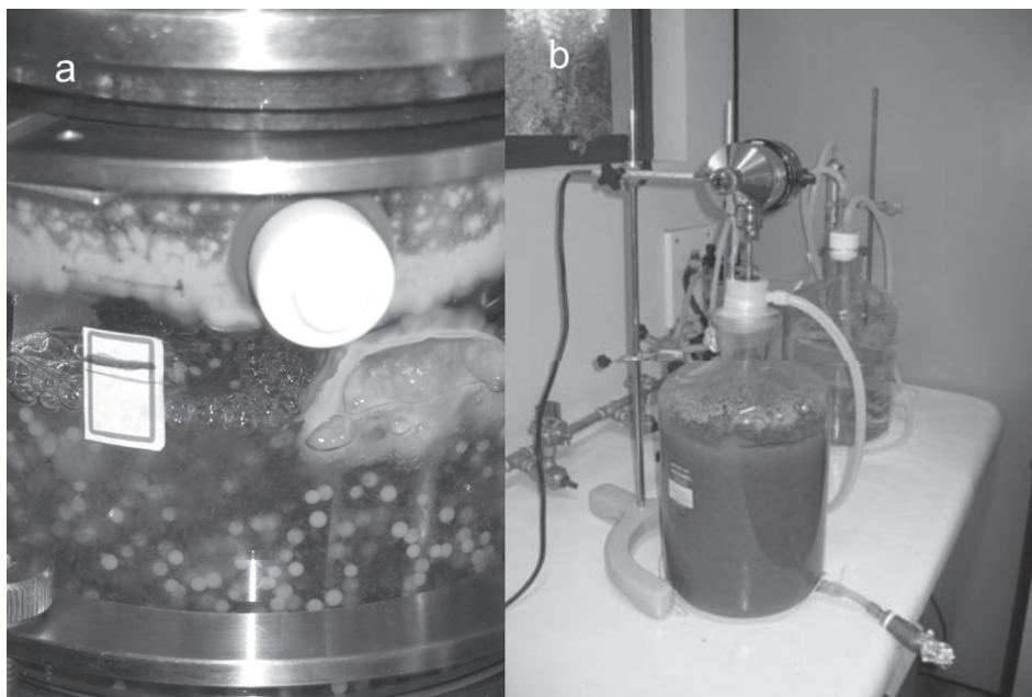
Figura 16.3 (a) Biorreator agitado por pás e (b) de baixo cisalhamento com agitação e aeração por tubo em L.
