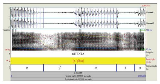
Figura 8 Oscilograma em 2 canais com *pulse* e espectrograma com *pitch,* intensidade e formantes da palavra "OITENTA", realizada como [o.'tʃ $\tilde{e}$ .tA].
