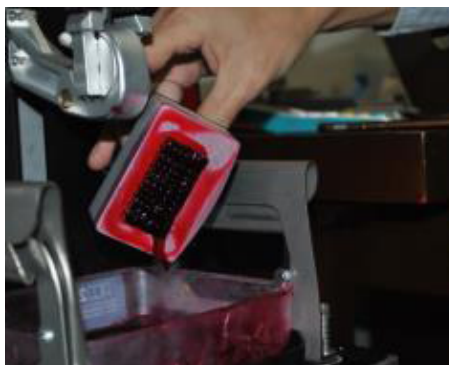
Fig. 2. Impresión 3D por rayos U.V del proyecto Texturas bioinspiradas con tecnologías de fabricación digital de la LIME. Fotografía: David Torreblanca.
