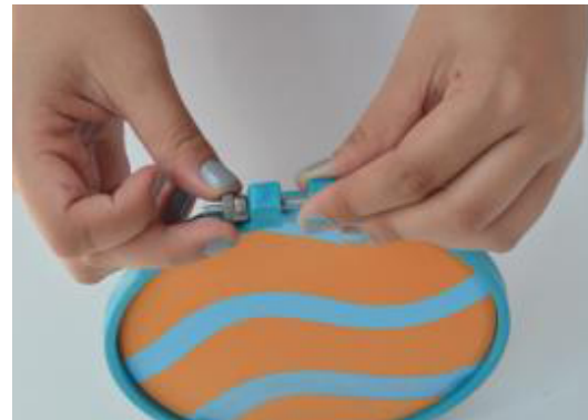
Figura 21(a) y (b). Técnica 29: membranas pre tensadas y curvatura. Una membrana elástica se tensiona en un marco se impregnan una zonas con resina, se deja secar, se retira el marco y la membrana adopta una forma tridimensional.
