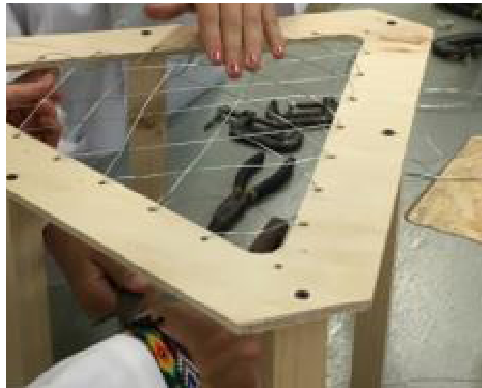
Fig. 19. Instalación “Biogénesis 2018”. Consta de una estructura geodésica de madera contra- chapada flexibilizada por corte láser y una piel de poliestireno deformado por calor y gravedad. Diseño de la LIME. Fotografías de Ever Patiño.
