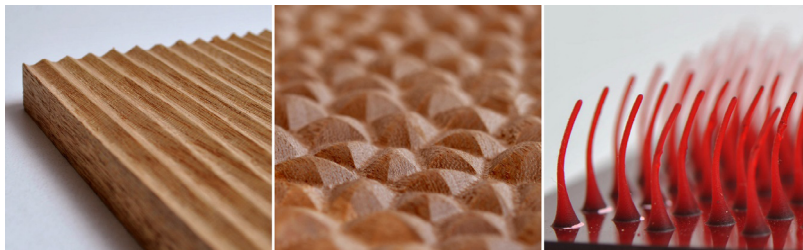
Fig. 29. Muestras de texturas bioinspiradas realizadas a través de las tecnologías de la tecnología FDM ( Fused Deposition Modeling ), marcado con láser y fresado por CNC ( Computer Numerical Control ). Fotografías de David A. Torreblanca-Díaz.
