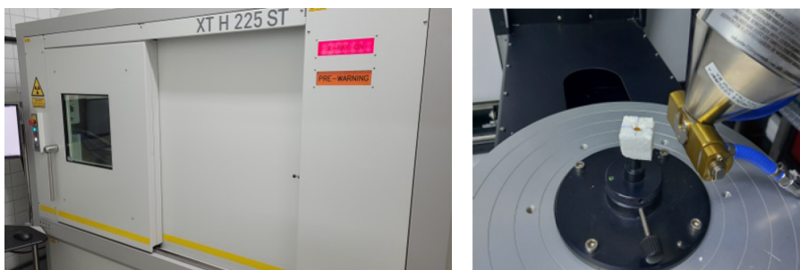
Figura 4: (a) XT H 225 ST. (b) Preparação da amostra para escaneamento Fonte: Autores
