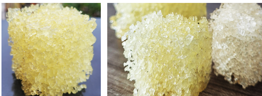
Fig.6: Impressão em resina flexível da estrutura bioinspirada.
