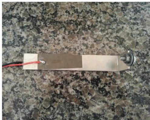
**Figura 24.3.b** Placa com parafuso (simulando a falha).
