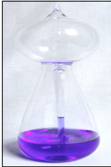
Figura 2 – Ebulidor de Franklin – ao variar a temperatura ocorre um aumento de pressão deslocando do líquido para cima.
