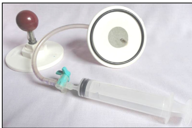
Figura 1 – Placas de Magdeburg: a pressão externa força um hemisfério tão fortemente contra o outro.
