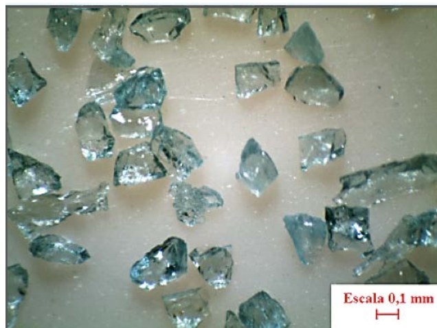
Figura 2. Imagem de microscopia óptica da apatita após cominuição e peneiramento na fração granulométrica - 180 + 150 \mu\text{m}
