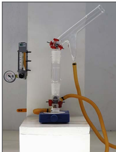
Figura 3. Tubo de Hallimond utilizado na realização dos ensaios de arraste hidráulico
