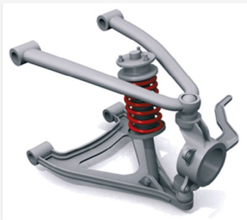
Suspensão Double Wishbone. Fonte: GTCarz. Disponível em: http://www.gtcars.ca/online/car-care-detailing-paint-visual-mods/42407-suspension-faq-all-you-need-know.html . Acesso em: 17/12/2012
