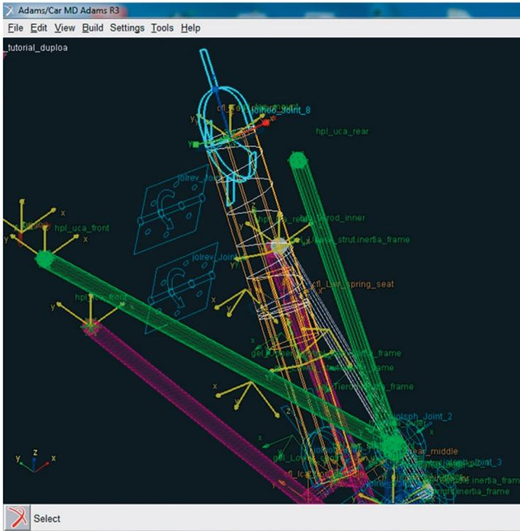
Figura 5.131 – Ilustração em destaque da junta *Hooke* construída.
