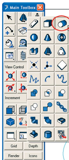
Figura 3.98(a) – Selecionando a ferramenta Cylinder .
