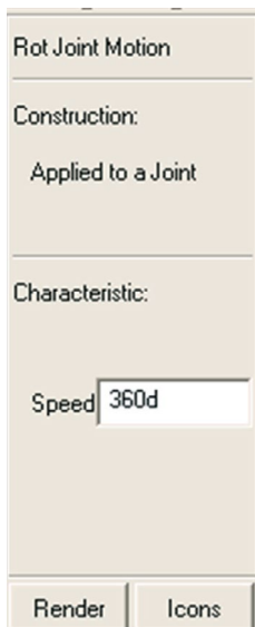
Figura 3.17 – Definindo a velocidade de rotação da came.
