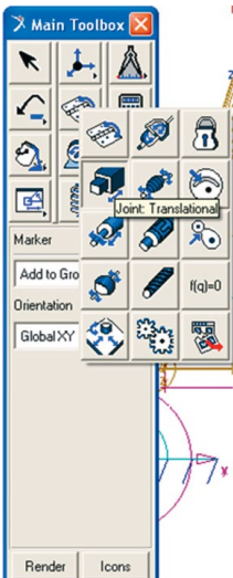
Figura 3.141(a) - Selecionando a ferramenta Joint:Translational .
