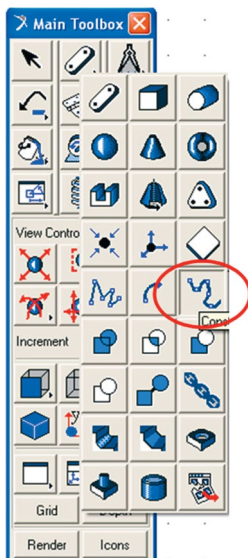
Figura 3.31(a) – Selecionando Spline .
