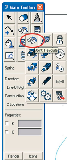
Figura 3.107(a) – Criando a junta revolute na came.
