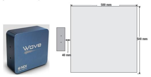
Figura 3 Gerador de campo WAVE (esquerda) e campo magnético (direita).
