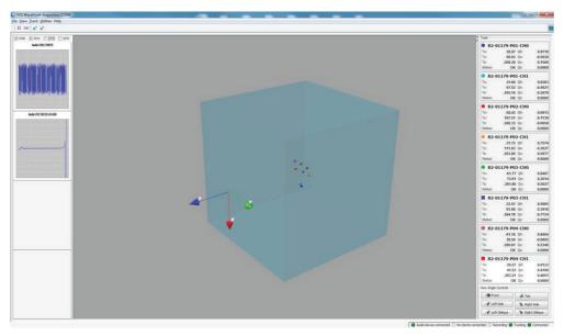
Figura 4 Exemplo da janela de captura do programa WaveFront com seu eixo tridimensional e, nesse caso, oito sensores sendo gravados.
