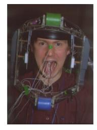
Figura 1 Exemplo de um Articulógrafo 2-D AG-200 utilizado em meus experimentos na USC.
