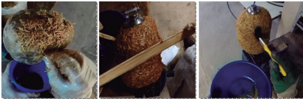
Figura 14: Laminação da camada estrutural e instalação do componente modular.
