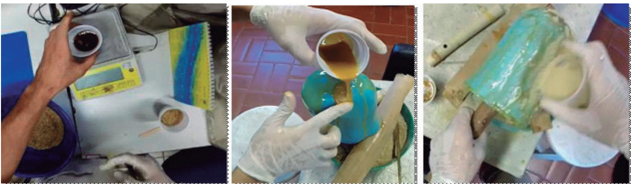
Figura 13: Pesagem dos componentes da resina, preparação do molde e laminação.
