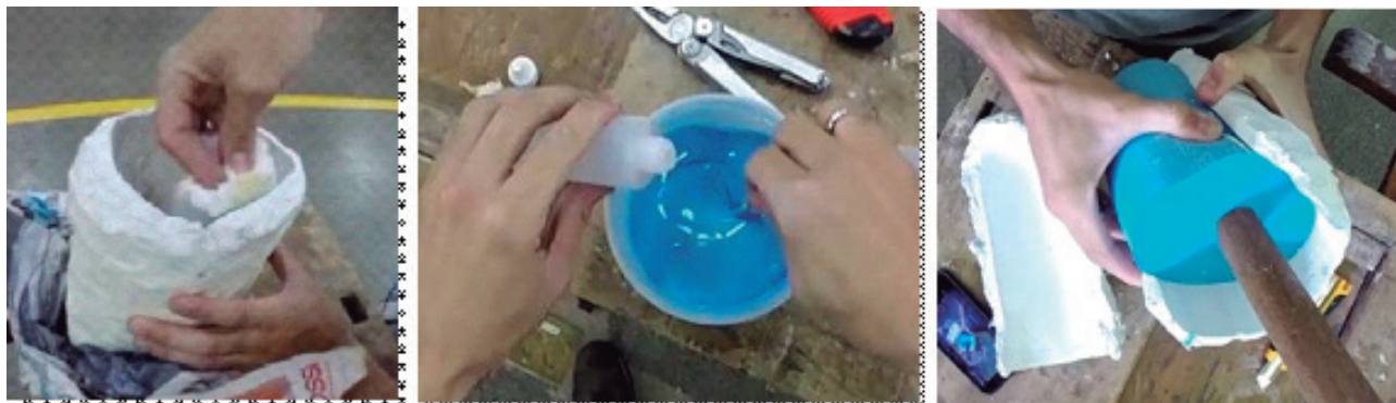
Figura 10: Preparação do molde negativo e do silicone para confecção do molde positivo.
