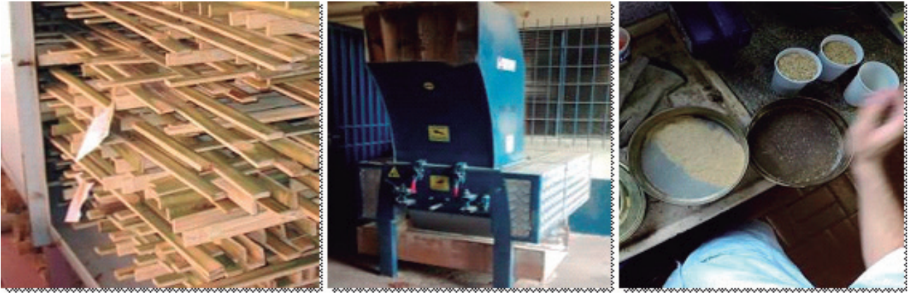
Figura 12: Ripas obtidas, moinho de martelos e fibras obtidas pela peneira.
