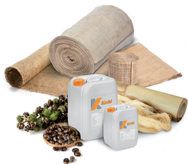
Figura 8: Matéria prima da matriz do biocompósito (sementes de Ricinus communis ) e exemplos de fibras naturais como linho, cânhamo, kenaf, algodão e bambu.
