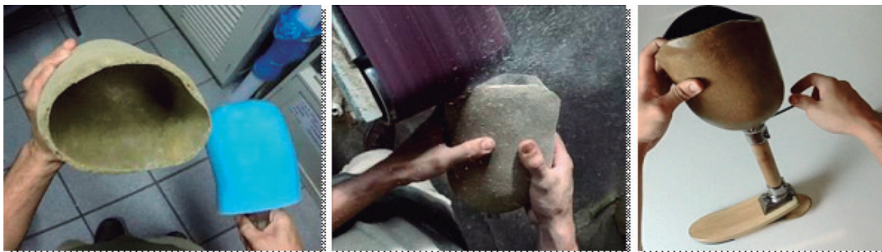
Figura 15: Retirada do soquete, acabamento e montagem do protótipo.
