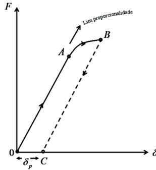
Fazemos o esforço ir de 0 até  $A$ , o limite de proporcionalidade. Ultrapassamos esse limite até  $B$ , e em seguida aliviemos o esforço até atingir  $F = 0$  e chegar ao ponto  $C$ . Temos, então, uma deformação permanente  $\delta_p$ , que não é o estado inicial, portanto, não houve regeneração, e sim degeneração do corpo sujeito à deformação. (1b)
