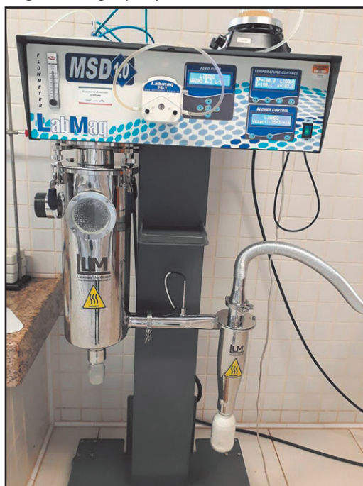
Figura 4 – Spray dryer utilizado neste trabalho
