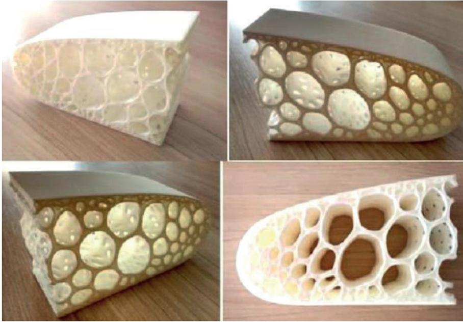
**Figura 2:** Impressão 3D como exemplo de aplicação de uma estrutura bioinspirada nas estratégias de leveza e resistência do Agave. Estrutura que pode ser emulada em uma ampla gama de artefatos (Araújo, 2015).
