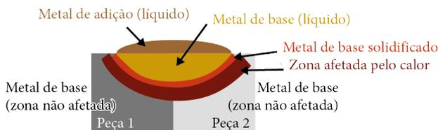
**Figura 4.5** – Processo de soldagem por fusão.
