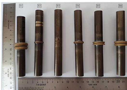
**Figura 4.7** – Sequência de amostras obtidas por soldagem por atrito rotativo para seleção do melhor ajuste de parâmetros para a liga UNS C64200. (Monteiro *et al.*, 2021)
