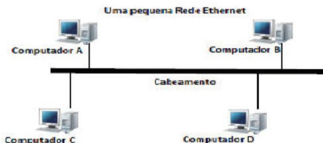
**Figura 6** Exemplo de uma rede ethernet.
